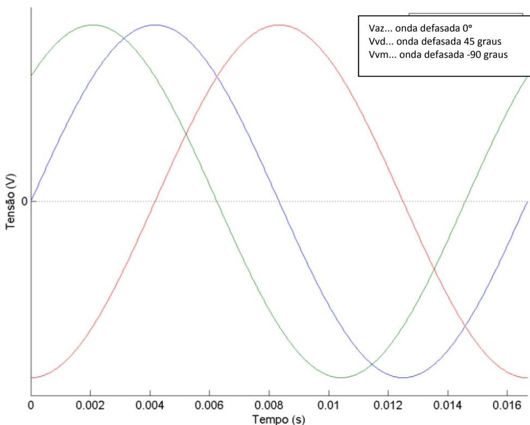
Considerando sequência  $v_{az}(t)$ ,  $v_{vd}(t)$  e  $v_{vm}(t)$ , e que elas têm amplitude máxima de 100 V, as equações do tempo dessas ondas são, respectivamente,
